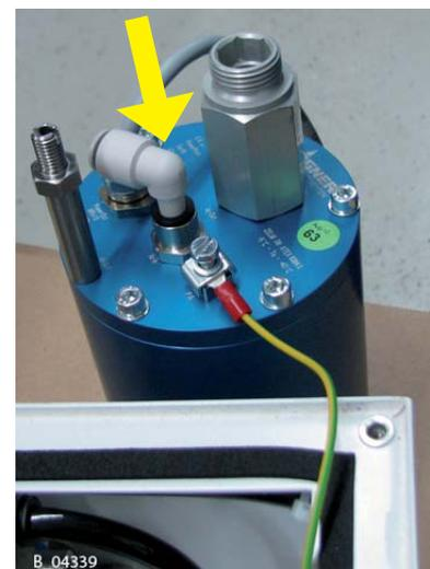
8. Turbine ins Steuergerät einsetzen und Luftschlauch anschliessen.
