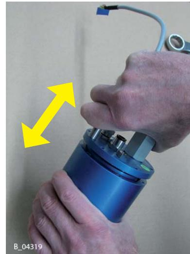
11. Die drei Schrauben des Generatorflansches lösen und entfernen.
